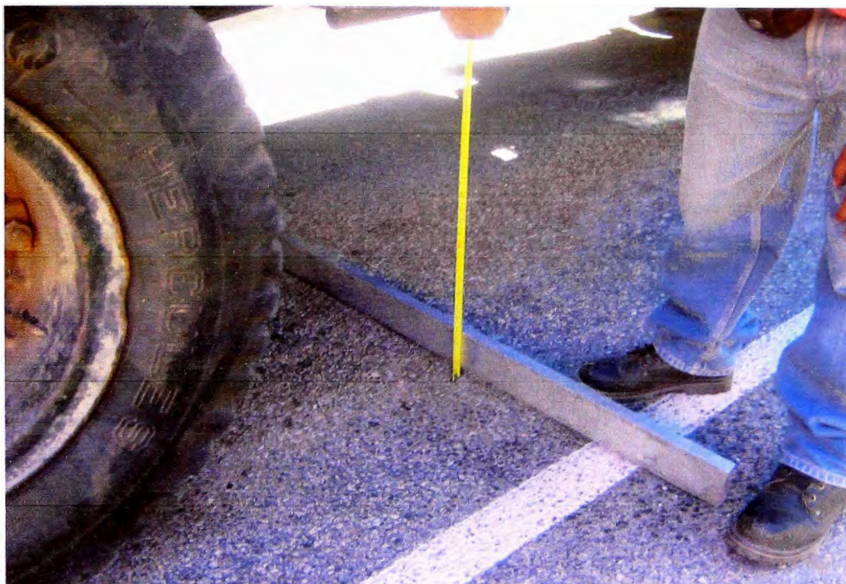
Figura N° 4.25: Medida del espesor de la superficie de rodadura (monocapa).
