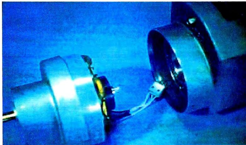
Fig. 52.- Desmontaje del alternador del magneto.
