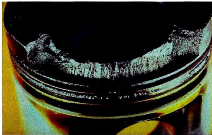
Fig. 8.- Daños de un pistón por pre-encendido.
