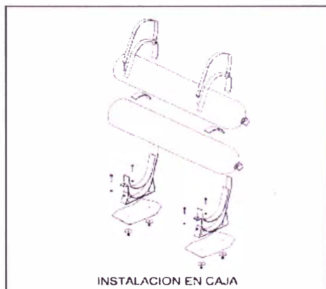
Fig. 10. Instalación de los cilindros de GNC [28]
