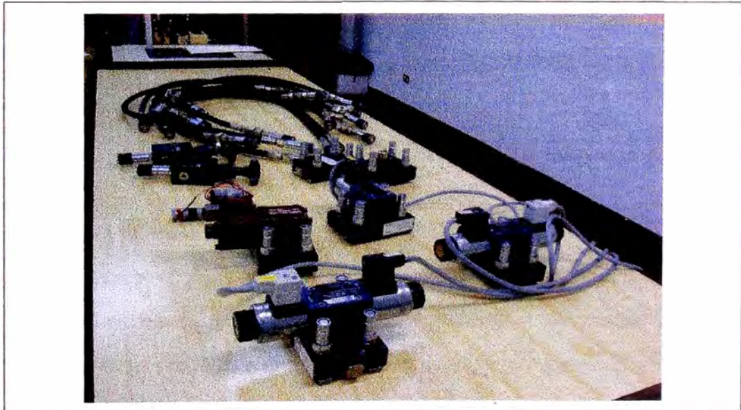
Fig. 9.7: Se muestra las válvulas del sistema electrohidráulico que serán reemplazadas por solo dos válvulas proporcionales.
