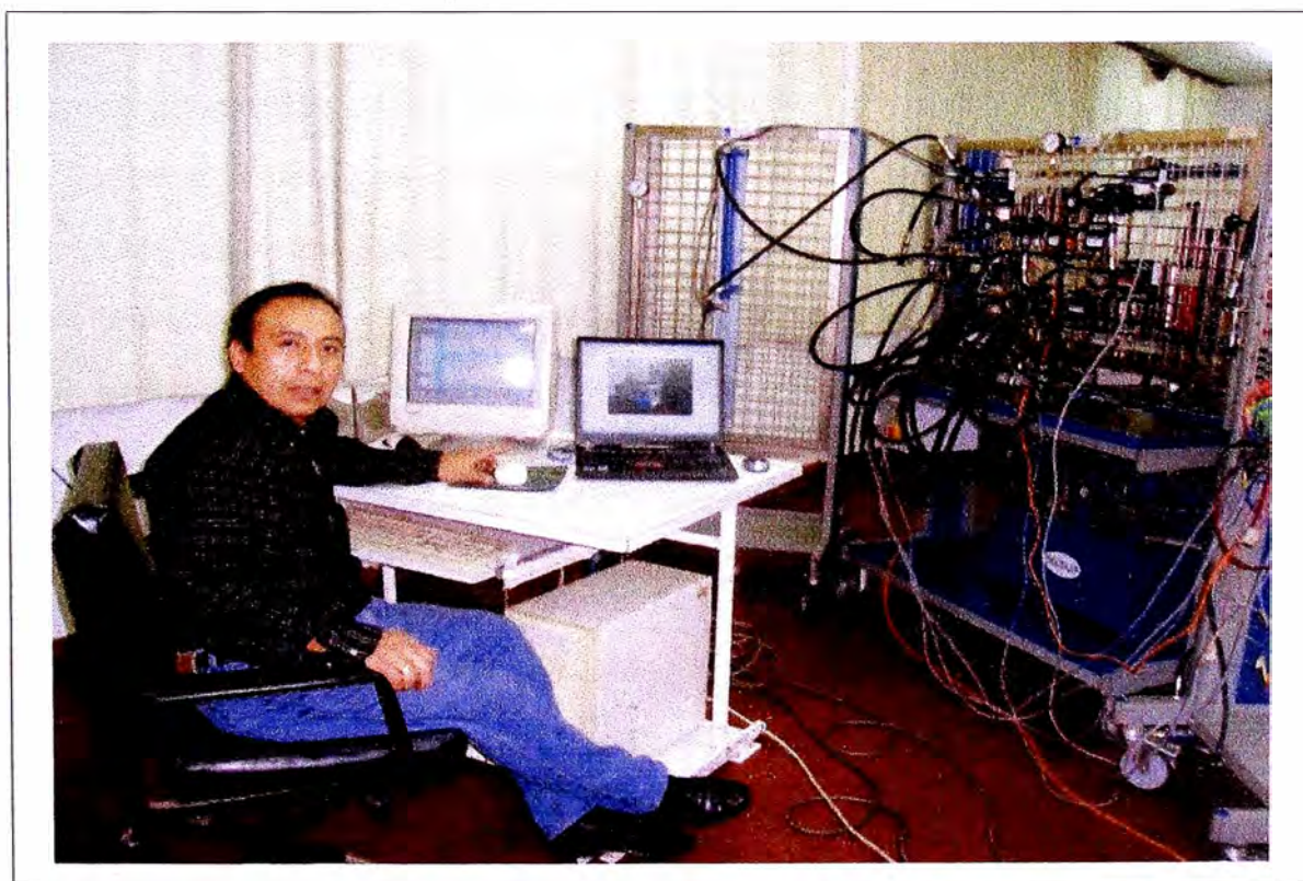
Fig. 1.12: Monitoreo de los parámetros de caudal y presión de la aplicación para una prensa hidráulica la cual ha sido totalmente diseñada y ensamblada para demostrar la viabilidad de la metodología descrita en el presente informe.
