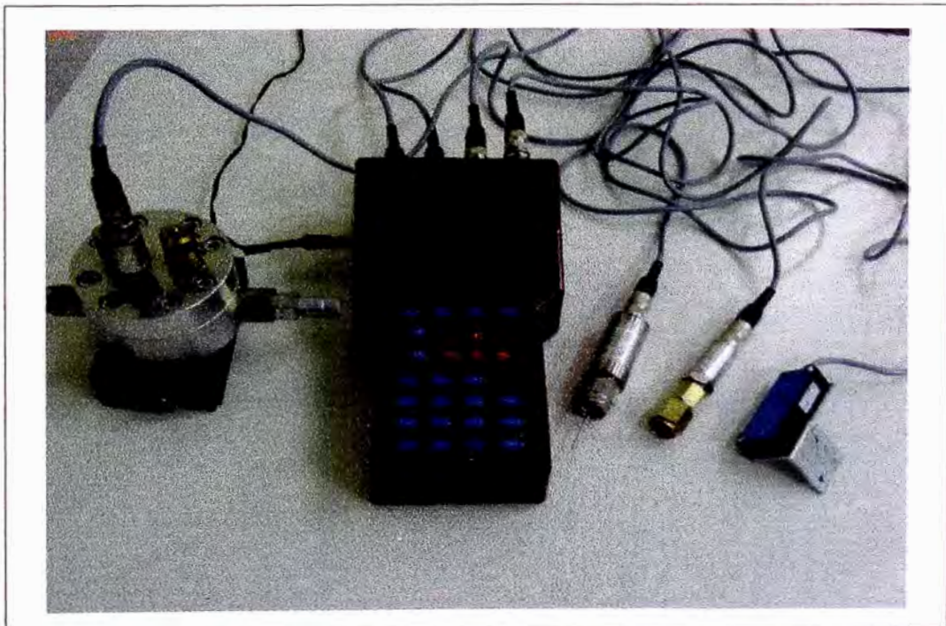
Fig. 9.32: Equipo de monitoreo de campo. Permite observar las variables de presión, caudal, temperatura y rpm. No permite leer las variables de entrada y salida a la tarjeta de control proporcional y se circunscribe solo a un monitoreo hidráulico. Su costo es de 5900 € FOB = $ 8260 FOB. Costo $ 11535.8 CIF (Tomando en cuenta el 33 % + costos de almacenaje, desaduanaje e inspección citado en la Tabla 9.10).
