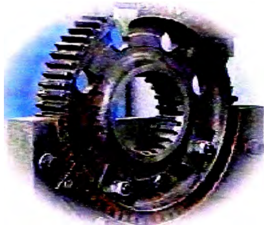
Fig. 7. Engranaje de caja de cambio endurecido por carbonitruración en horno a gas natural
