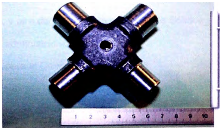
Fig. 4 . Cruceta endurecida por carbonitruración en horno a gas natural
