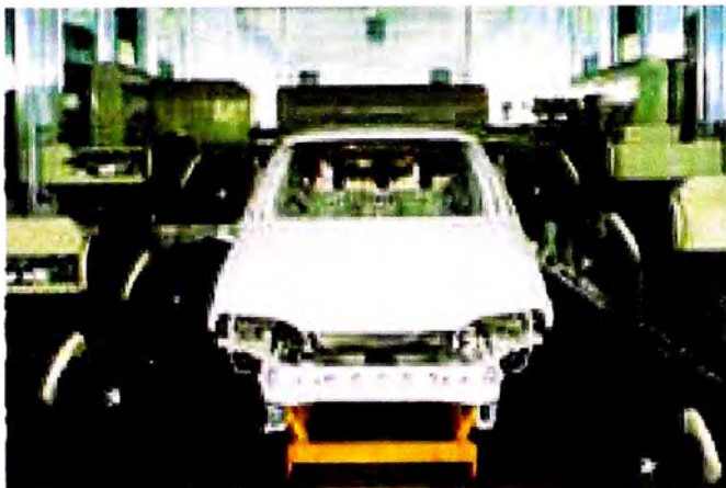
Fig. 6 . Carrocería pintada sobre skid
