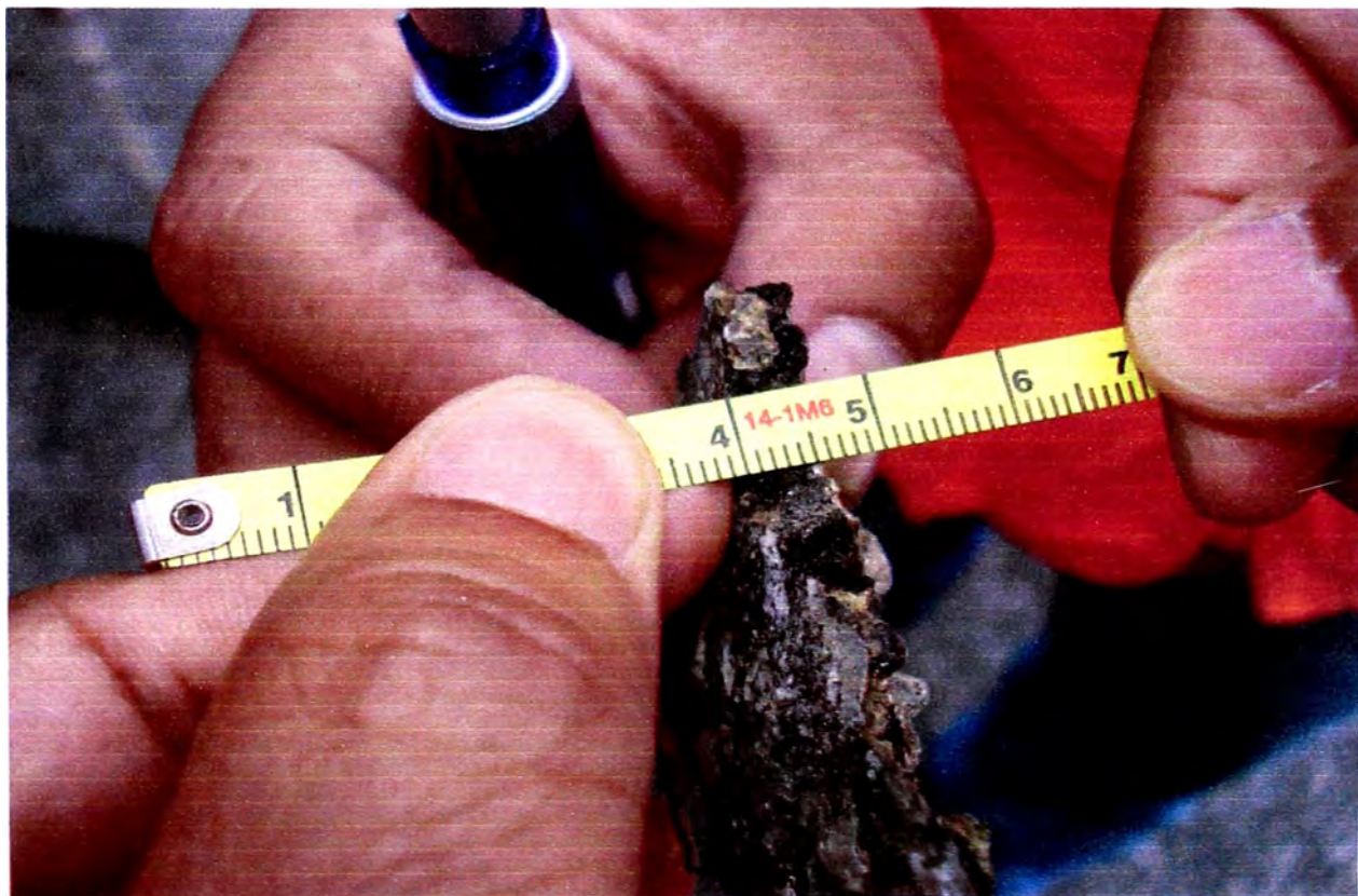
Fotografía 4.04 Espesor de la superficie de rodadura
