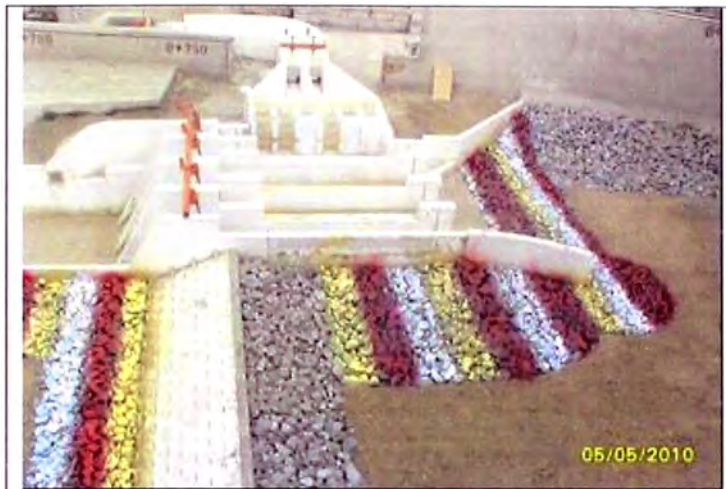
Foto N° 6.57.- Se observa el modelo hidráulico de la Bocatoma con los cambios adicionados.
