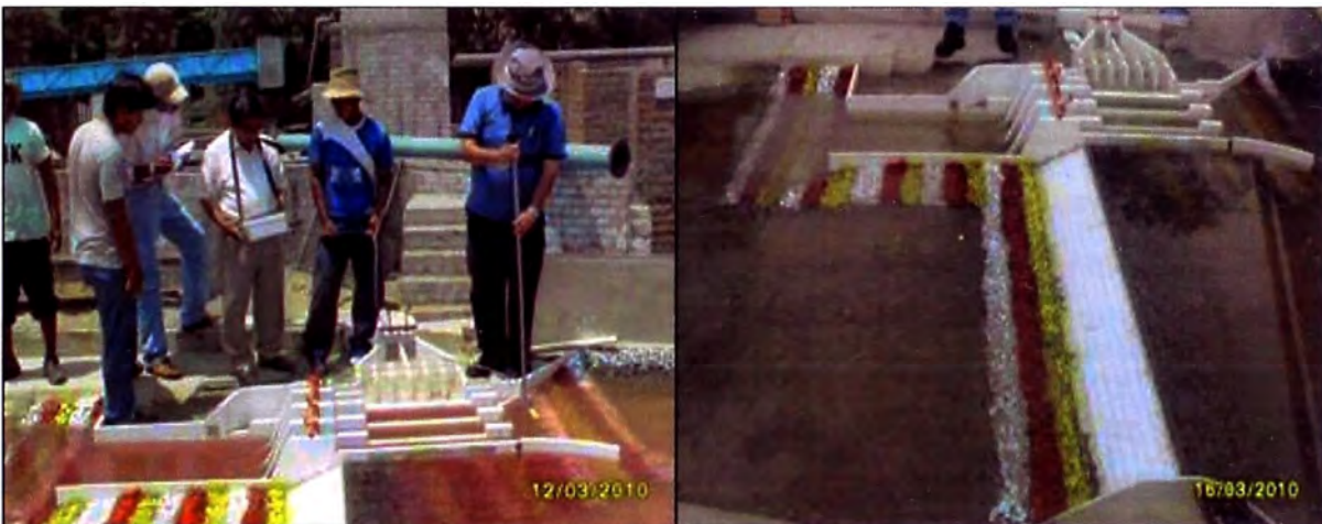
Foto N° 3.43.- Utilización del correntómetro digital para medir las velocidades en los diferentes puntos de interés.
