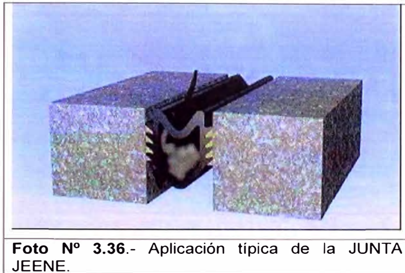
Figura 3.4: Corte de la aplicación de la Junta Elastométrica Jeene
