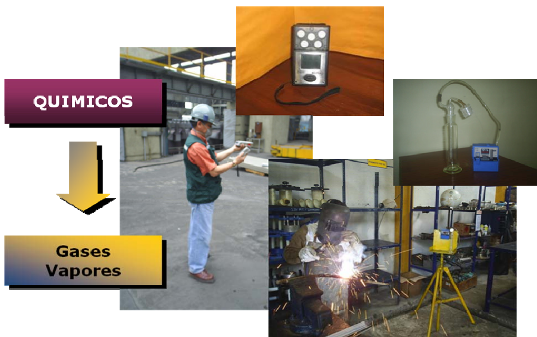
Figura 2.3G : Monitoreo de la concentración de Gases y Vapores
