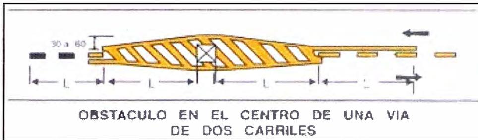
**FIGURA N° 2.10. SEÑALIZACIÓN CON OBSTACULO EN LA VIA**
