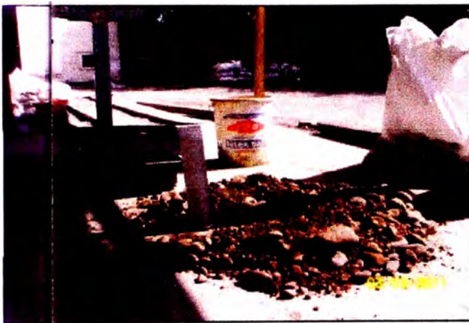
foto N° 1 : Material a ser ensayado. Se puede apreciar el material menor de 4".
