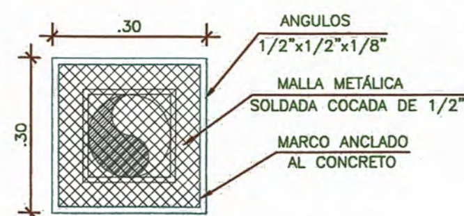
DETALLE DE MALLA METÁLICA ESCALA 1/10
