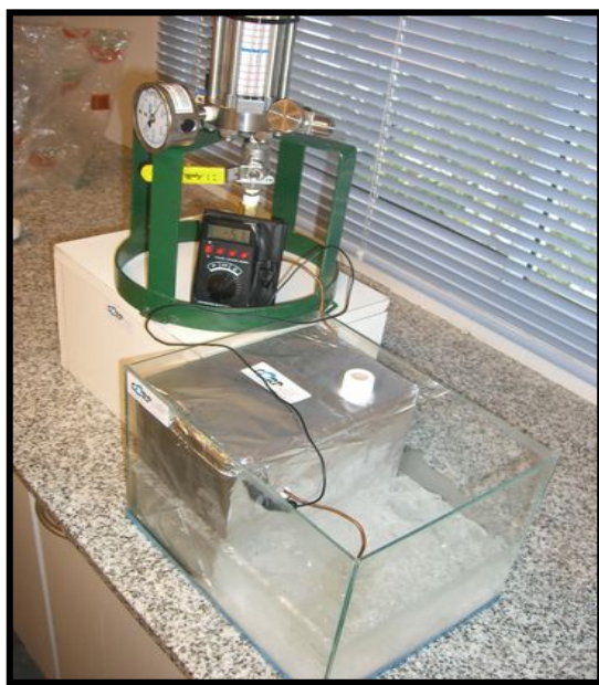
Fig. 6. Esquemas del dispositivo criogénico para la extracción de pequeños volúmenes de LGN y la preparación de viales de ensayo
