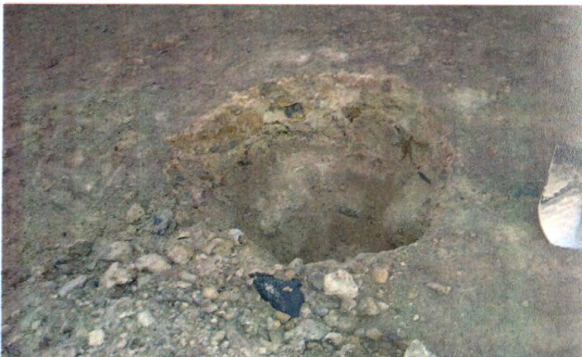
FOTO N° 06: Calicata de exploración en la zona del reservorio proyectado, se aprecia roca disgregada hasta una profundidad promedio de 50cm, a partir de donde se encuentra el macizo rocoso del cerro Miramar.
