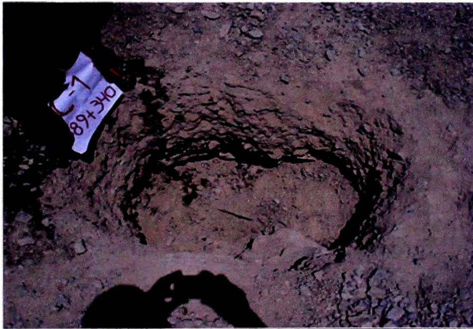
FOTO N° 4: Calicata en la progresiva 89+340.
