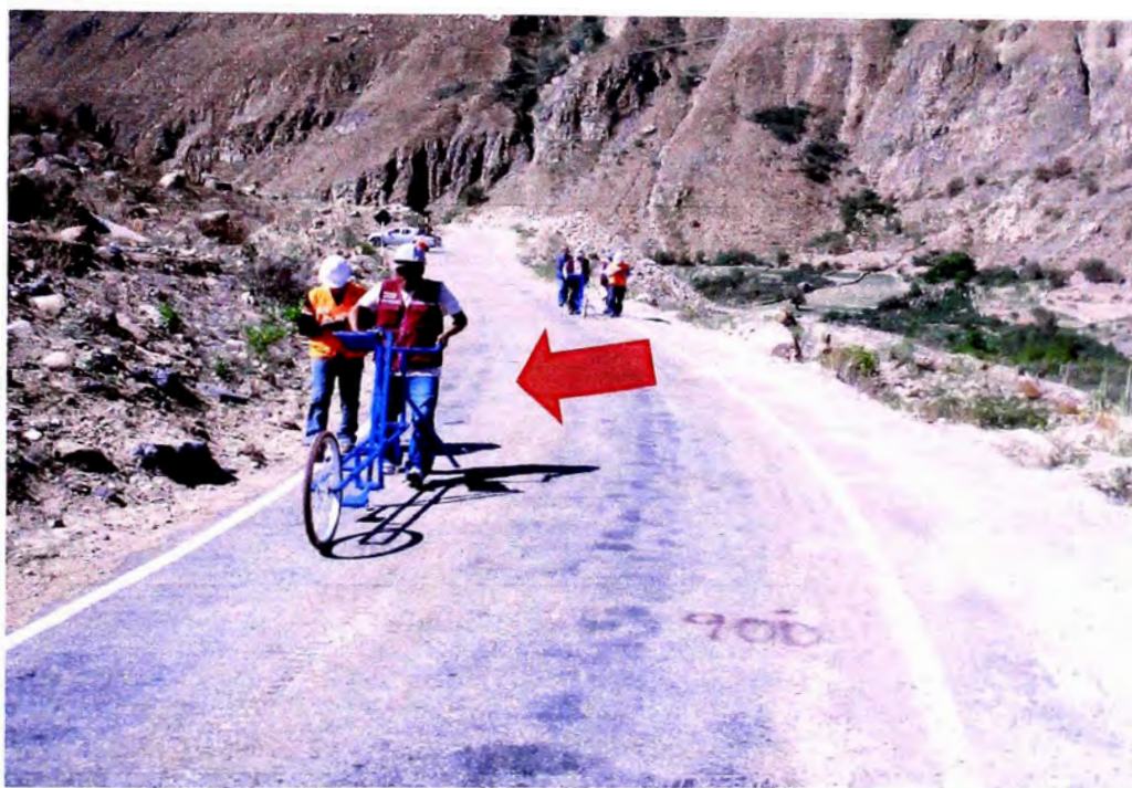
Foto N°02: En esta vista se aprecia el instante en que se realiza el ensayo de rugosidad de MERLIN, así como también se aprecia la toma de datos, Km 115+900.
