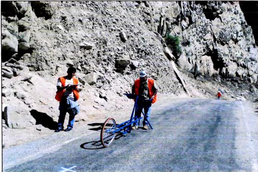
**Fotografía N° 19:** Medición con equipo Merlin para calibración del BI.
