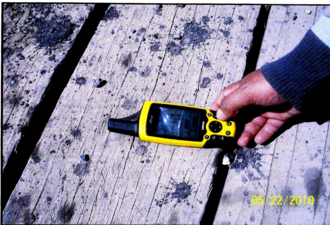
**FOTOGRAFÍA N°4.07: Medición de la altura en m.s.n.m.**
