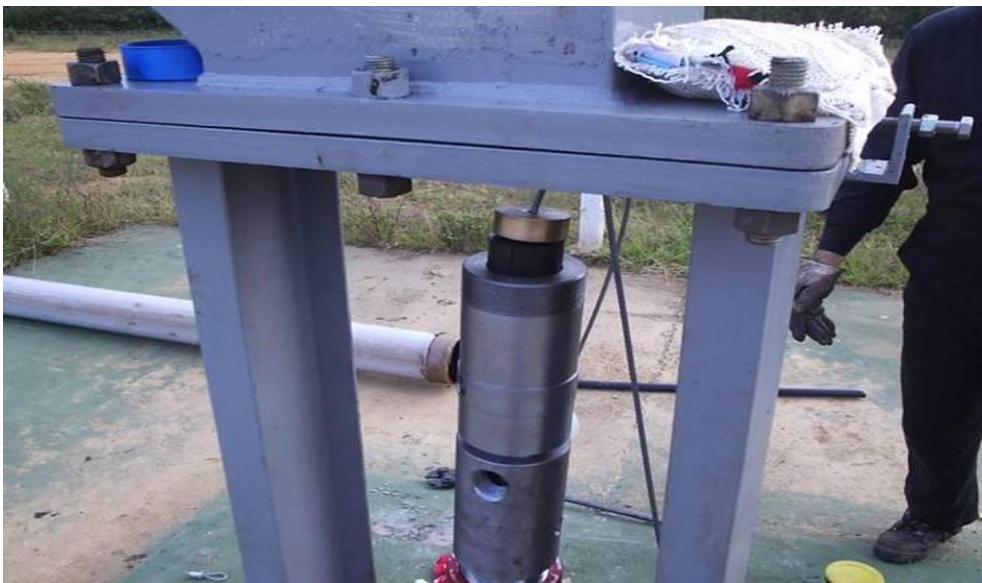
Fig. 6.9 Sistema de Sellos Para Evitar Fugas
