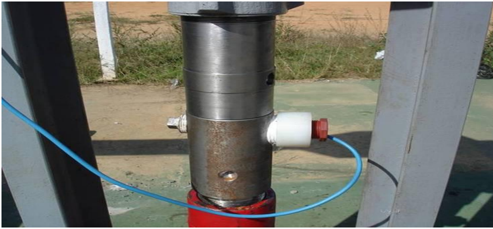
Fig. 6.10 Sensor de arribo del tubo de aspiración
