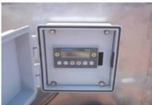
Fig. 2.5 Un panel, de cristal líquido externo (magelis) que permite visualizar y modificar un gran número de parámetros, que brindan estadísticas de producción, rendimiento y eventuales fallas.
