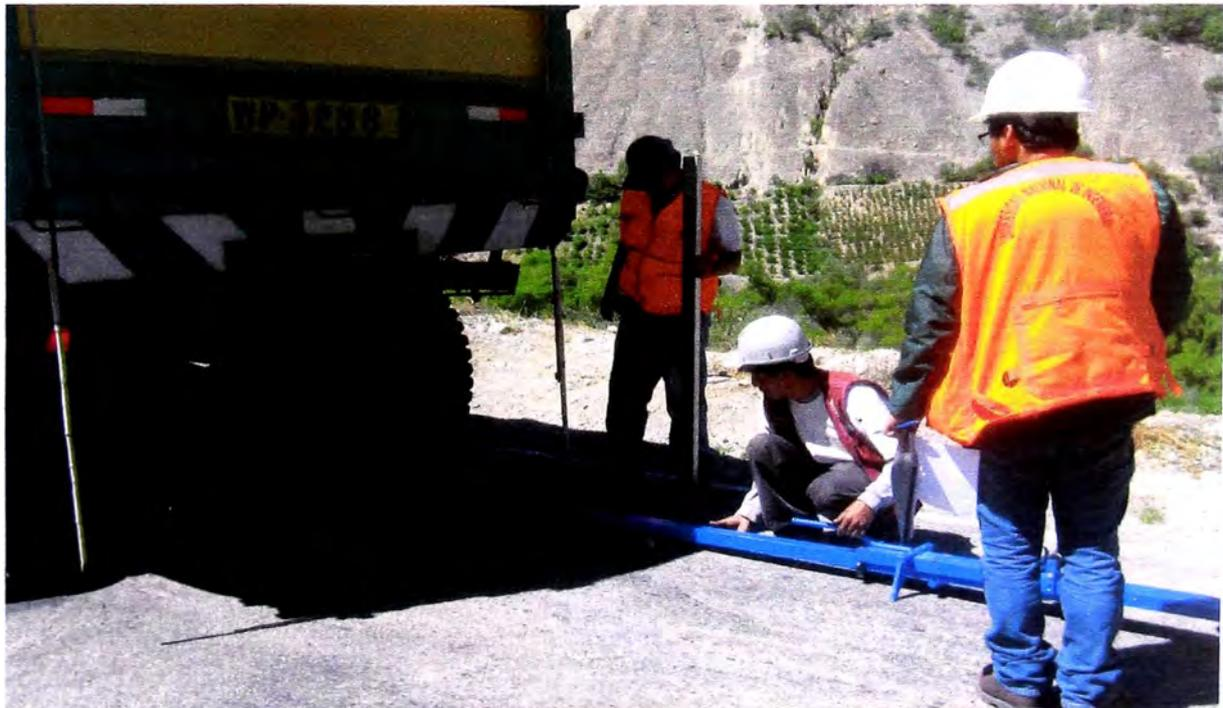
**Foto N°02: Posicionamiento del equipo Viga Benkelman, para el inicio de las mediciones de deflexiones**
