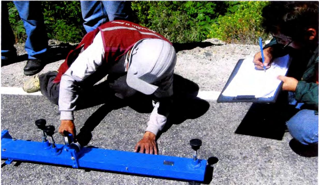
**Foto N°03: Recopilación de datos de deflexiones con Viga Benkelman.**
