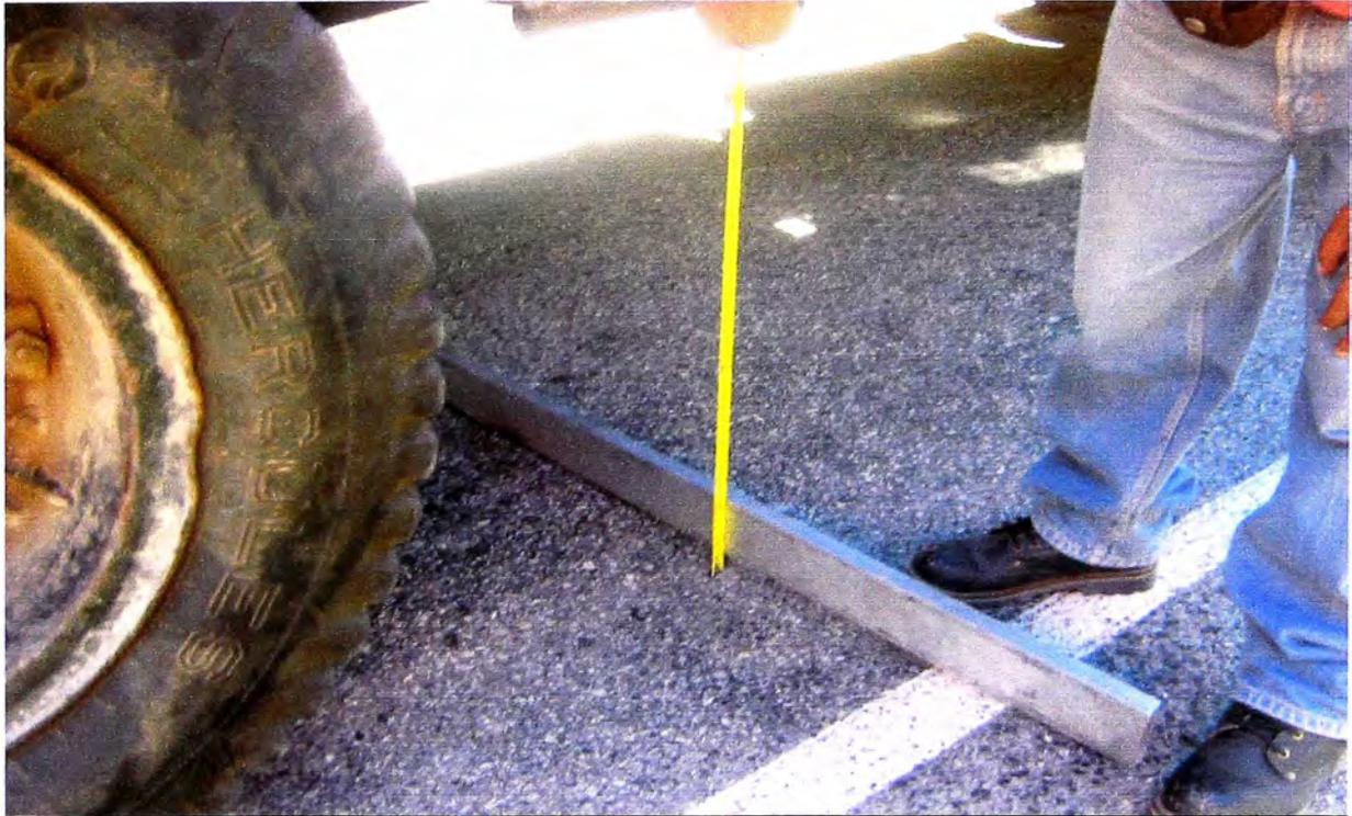
**Foto N°05: Medición del ahuellamiento**
