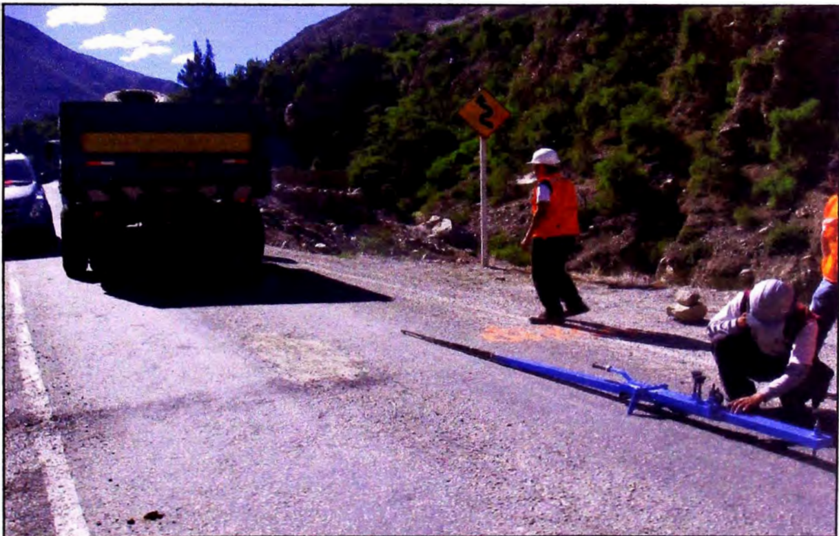
Luego de la partida del camión y con una distancia considerable entre este y la viga (mayor a 5m), se toma la medición de los diales.
