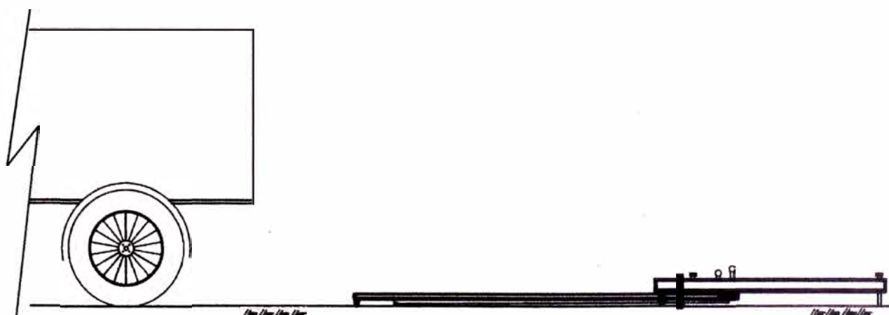
Figura N° 3.12. Estado final del ensayo (recuperación elástica máxima del pavimento).
