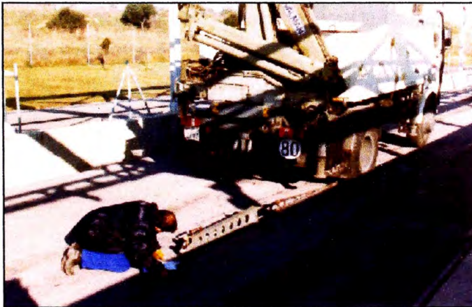
Figura N° 2.1. Imagen del ensayo de deflexión con viga Benkelman.
