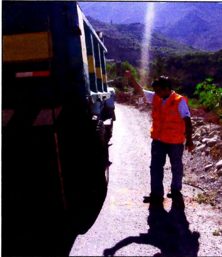
Estacionamiento del vehículo (eje posterior sobre la progresiva a evaluar y sobre la zona de ahuellamiento).
