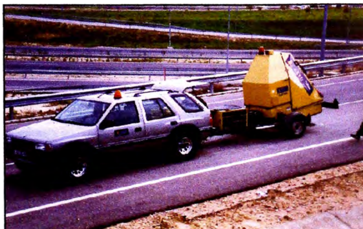
Figura N° 3.4. Equipo KUAB – FWD.
