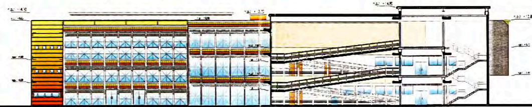
CORTE-ELEVACION RAMPA -ESCALERA PRINCIPAL
