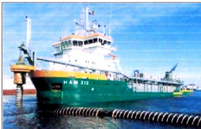
Figura N° 2.2: Dragas descargando el material a través de una tubería flotante
