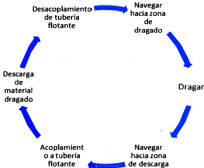
Figura N° 2: Fases del ciclo de dragado
