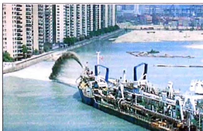
Figura N° 2.3: Dragas de succión vertiendo el material mediante impulsión con el sistema “chorro de proa”
