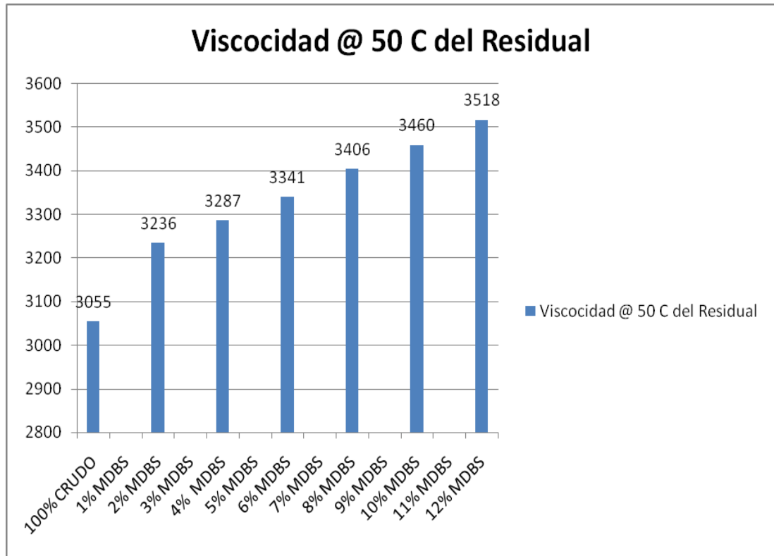
Figura N° XIV.11: Viscosidad (a 50°C) del Residual vs. Porcentaje (%) de MDBS en el Crudo
