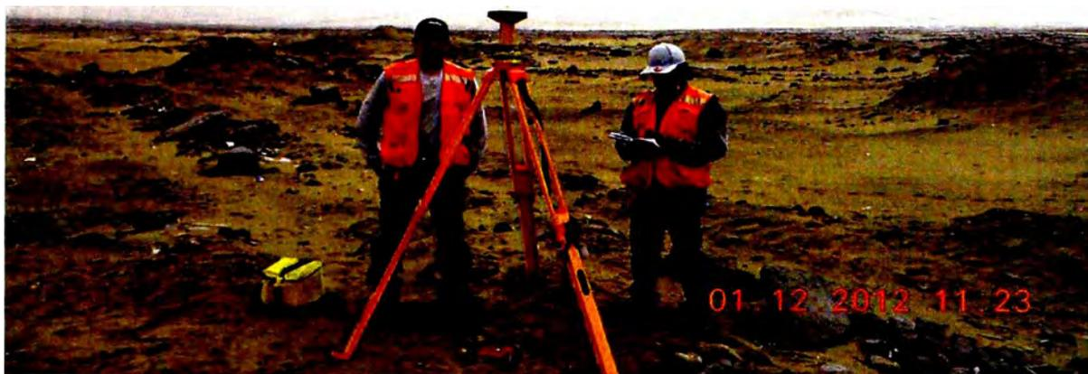
Figura N°3.3.- GPS Diferencial en modo Estático
