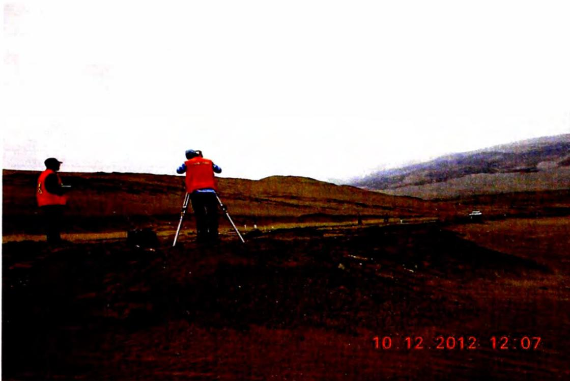
Figura N°3.9.- Levantamiento por radiación con Estación Total
