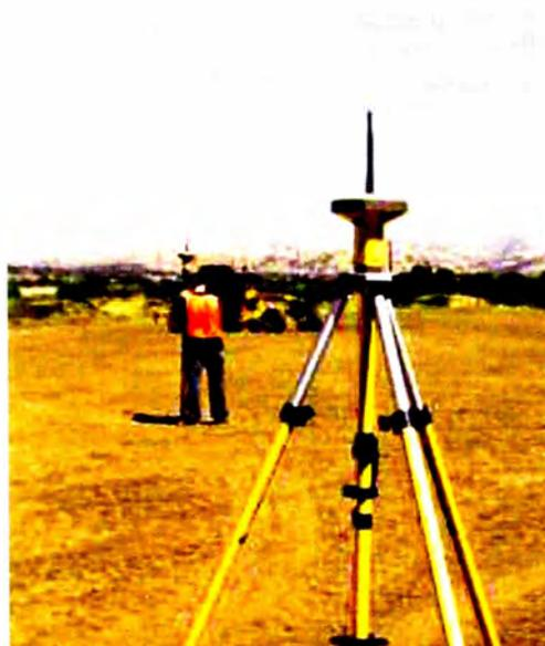
Figura N°2.11.- Replanteo topográfico en RTK
