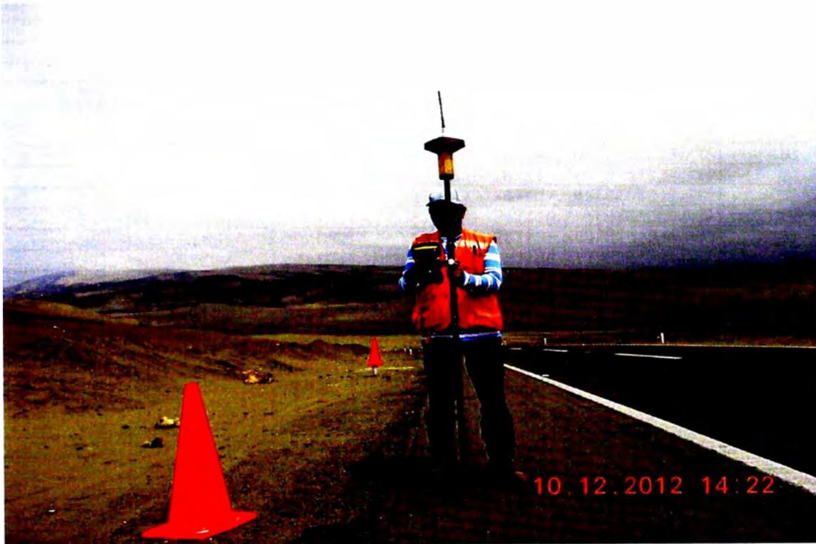
Figura N°3.11.- Levantamiento en modo RTK
