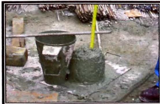
**5.01.05 Consistencia:** El slump depende del elemento a vaciar como elementos verticales y/o horizontales, las dimensiones de este la cantidad de acero, etc.
