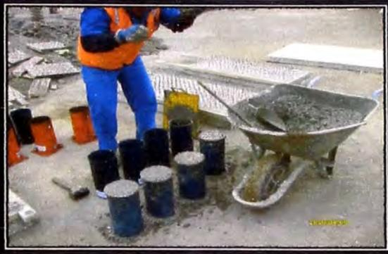
El concreto que se utiliza es premezclado, con slump de 4" ya que hay mayor espacio para manipularlo.
