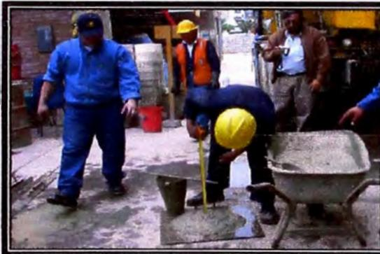
El concreto que se utiliza es premezclado, con slump de 6"-8" o rheoplástico de slump de 10" esto debido al espesor de los muros.
