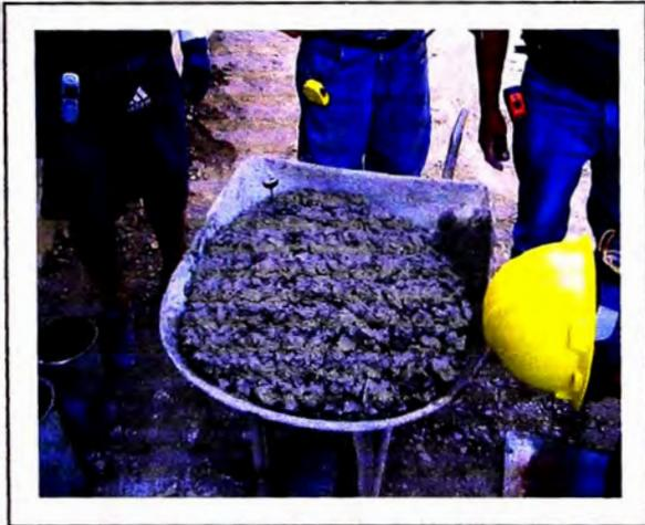
Prueba de slump del concreto en obra
