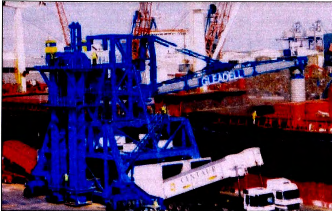
Foto N° 2.05 : Embarque de concentrado de cobre mediante el Shiploader, almacén y faja tubular.
