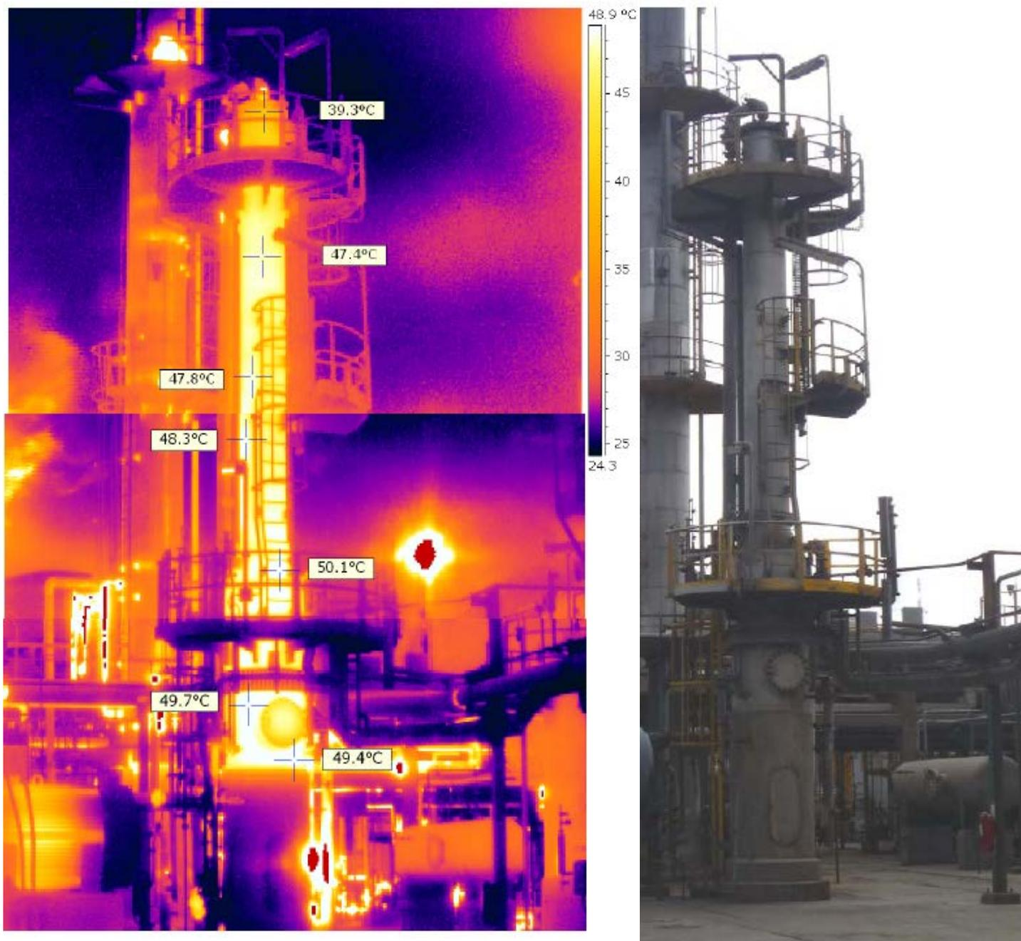
Foto 2: Termografía y vista del Absorbedor durante la segunda parte de la prueba
