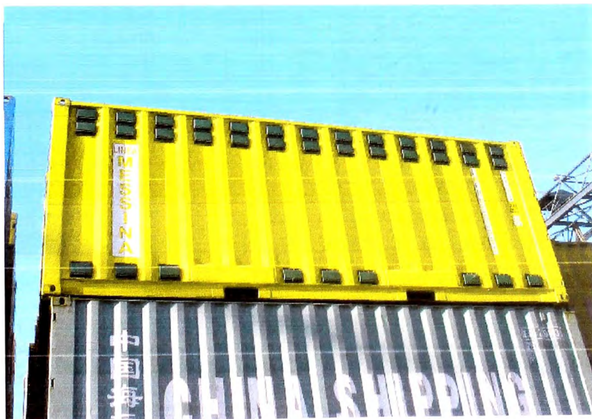
Fotografía N°2.11 Contenedor ventilado de 20'
