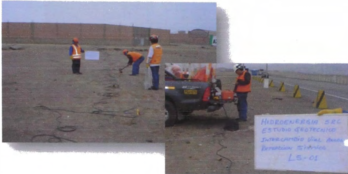
Foto N°13: Línea sísmica Ls 01, registro de ondas P
