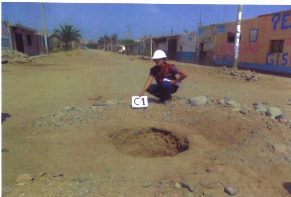
Calicata C-1: Esta calicata de 1.50 m de profundidad se realizo en la zona del centro poblado, en la intersección de la Avenida Principal y Avenida Grau.
