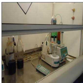
GRAFICO 2-17: PROCEDIMIENTO DEL METODO DEL (UOP 163-67)
