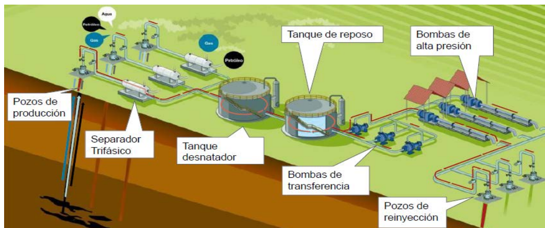
Fig 8.2 Reinyección de agua
