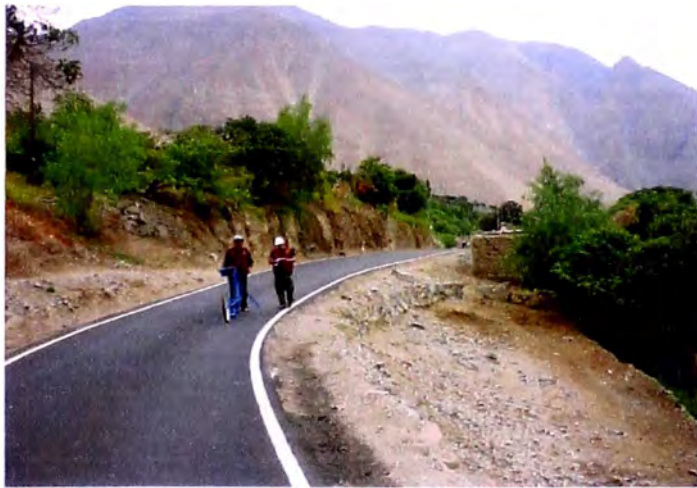
Progresiva 79+800. Vista hacia Catahuasi, en donde se hacen mediciones con el equipo MERLIN
