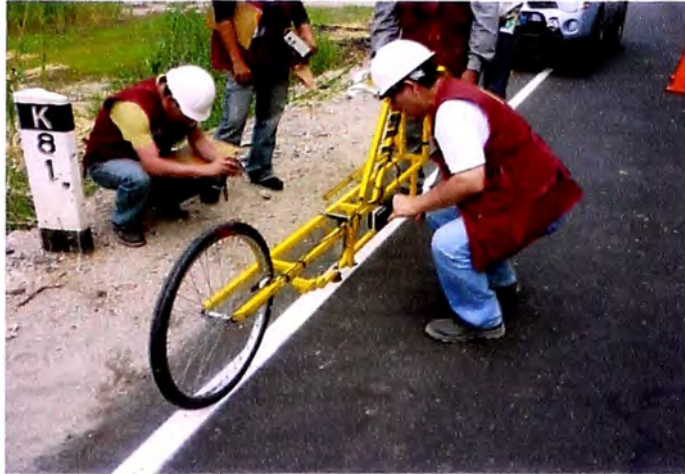
Progresiva Km 81+000. Verificación del factor de corrección del equipo mediante el empleo de un disco de 5 cm. de diámetro y 6 mm. de espesor
