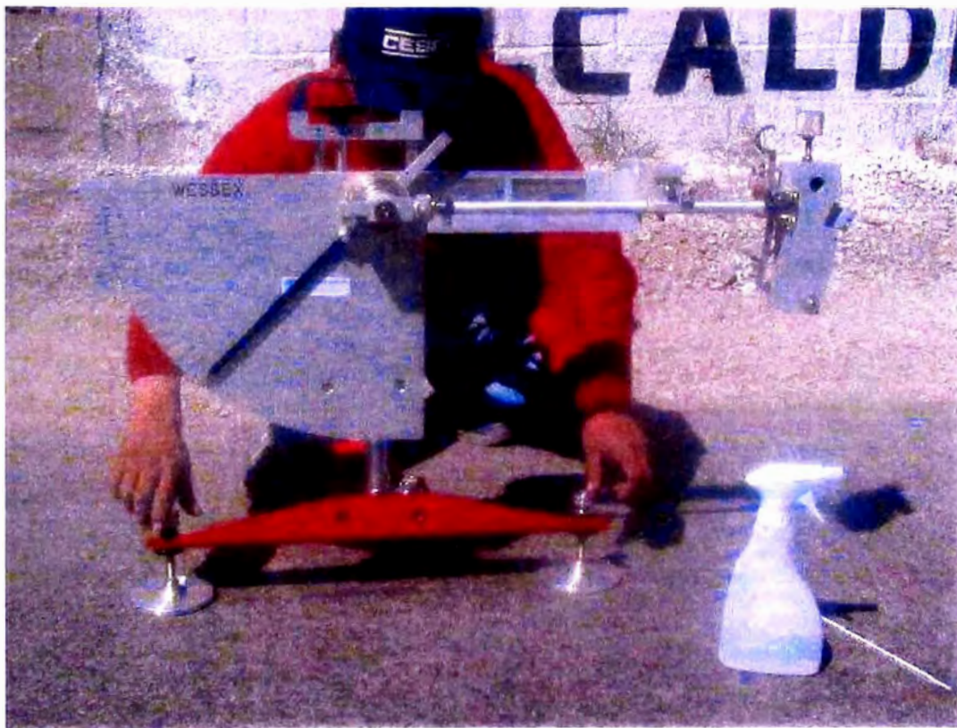
FIGURA N°2.4 MEDICIÓN DEL CRD CON PÉNDULO TRRL
