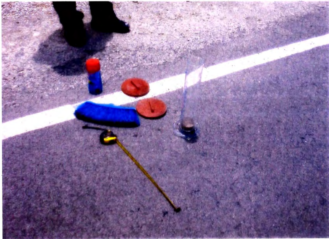
FIGURA N°2.5 MEDICIÓN DE MACROTEXTURA
