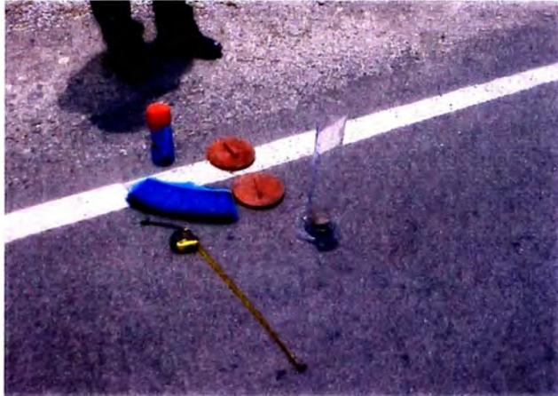
**MEDIDA DE LA ARENA CON LA PROBETA GRADUADA**
