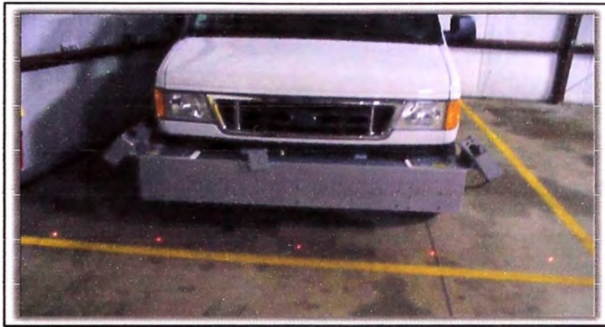
Figura N° 2.02 Vista frontal de la camioneta mostrando los láseres.
