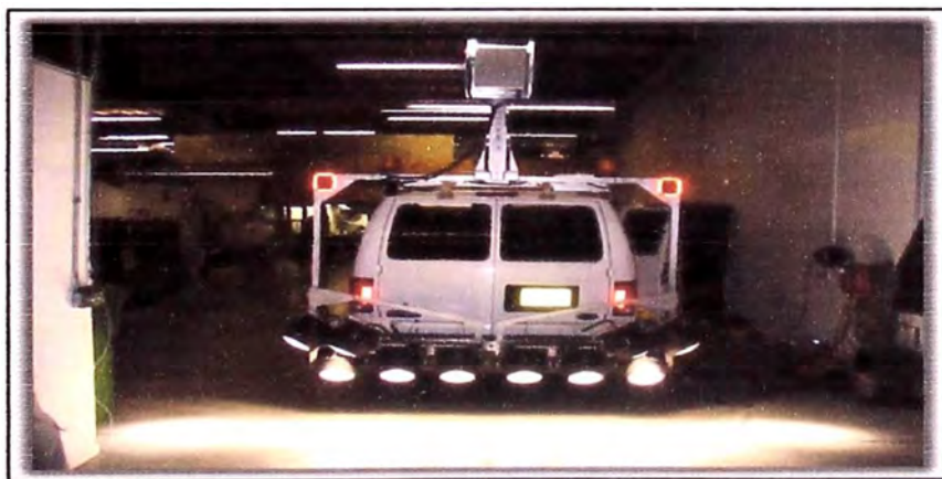
Figura N° 2.03 Vista posterior de la camioneta que muestra el sistema de iluminación y cámaras para obtener imágenes de superficie del pavimento.
