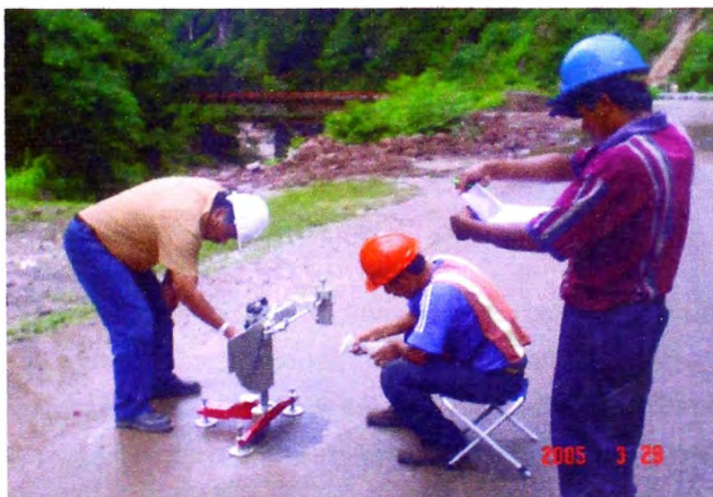
Figura N°2.02 Toma de registros de campo con el Péndulo TRRL
