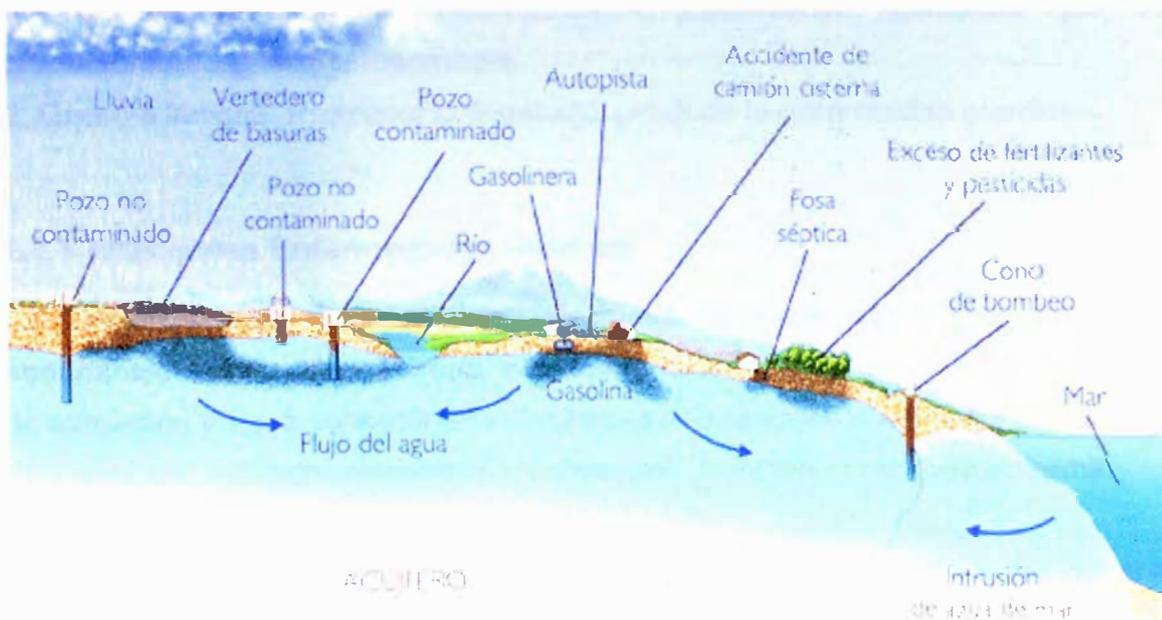
Figura N° 2.10: Esquema de Contaminación de Agua Subterránea
