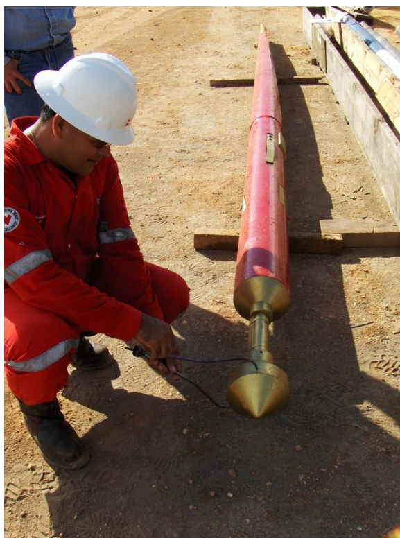
Figura 38. Inspección del Whipstock en superficie
