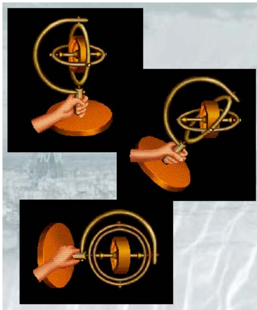
Figura 35 – Principio de Funcionamiento del Gyro
