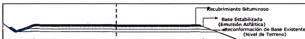
Figura N° 1-1. Esquema de conformación de la plataforma en una sección transversal típica de pavimento económico.
