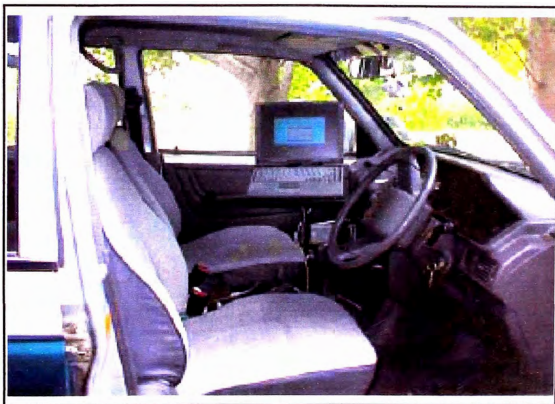
Fotografia N° 02: Instalacion del Adquisidor de Datos
