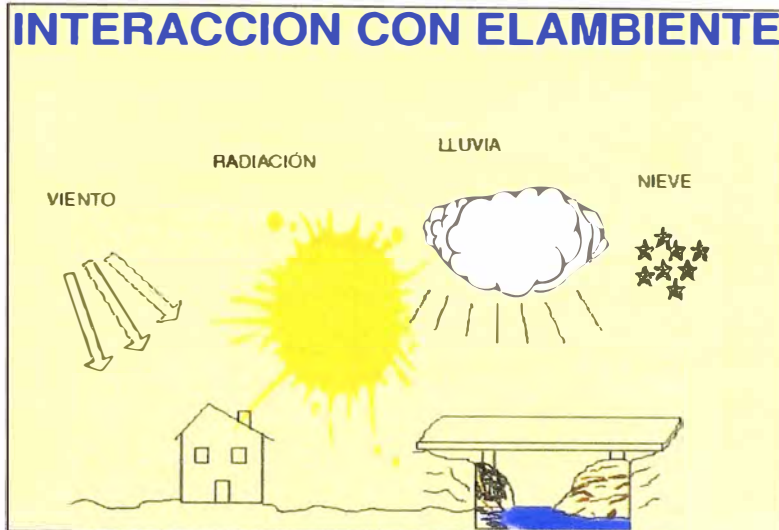
Grafico N° 3.18, Causas de Deterioro de las Estructuras de Puentes Fuente: Genner Villarreal Castro, "Construcción, Evaluación y Rehabilitación de Puentes", Lima, Perú, 2008.
