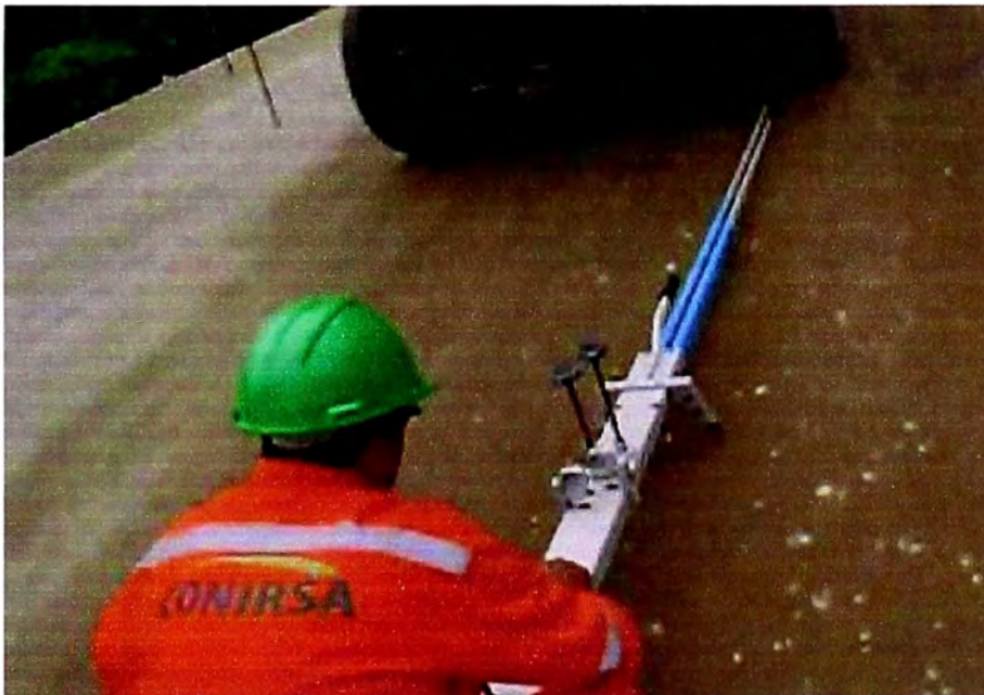
Figura N° 1.1. Viga Benkelman de doble brazo.
