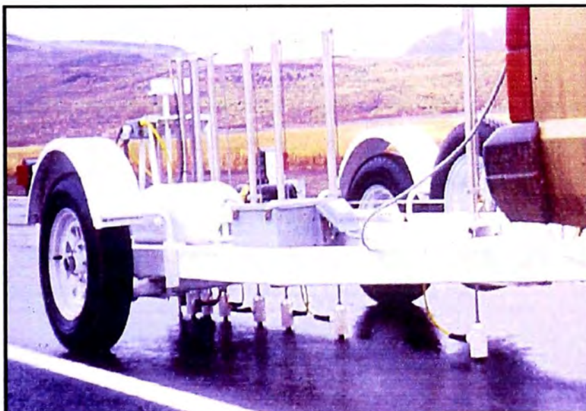
Figura N° 1.11. Equipo SASW - SPA.
