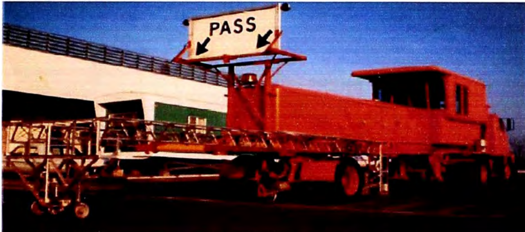
Figura N° 1.2. Deflectómetro móvil de california.
