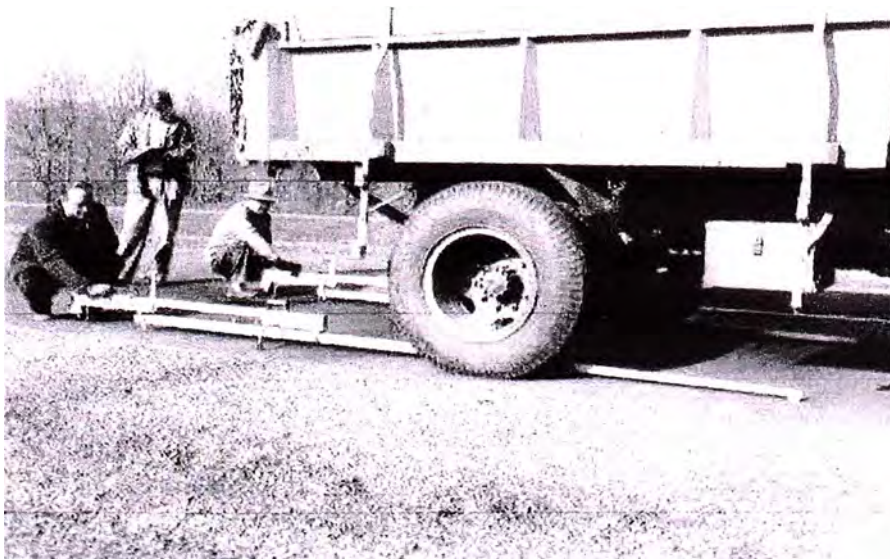
FIGURA N° 2.01. PRUEBAS CON VIGA BENKELMAN (1952)
