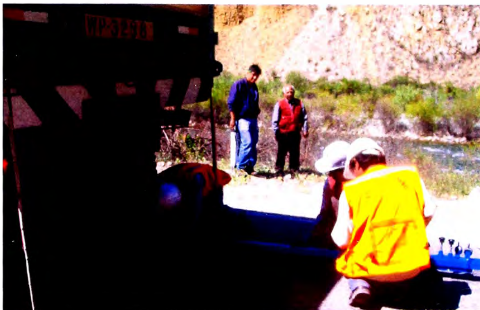
Foto 1: Preparación de la Viga Benkelman en el punto de ensayo para realizar las mediciones.
