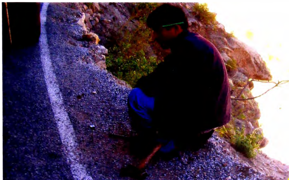
Foto 6: Extracción de una muestra de la carpeta de rodadura, con comba y cincel para medir su espesor.
