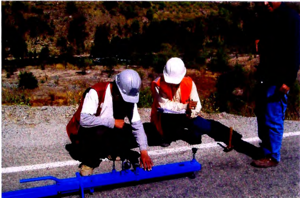
Foto 3: Proceso de medición de lecturas del dial de deformación, en el Km 118+000 de la carretera en estudio.
