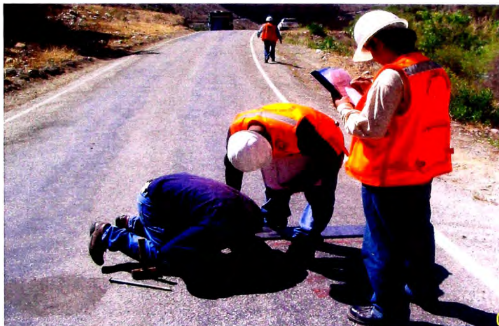
Foto 5: Medición del ahuellamiento en el punto de ensayo, con wincha y una regla de aluminio de 3m de longitud.
