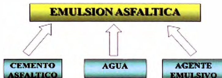
Figura 2.08 Componentes de la Emulsión Asfáltica
