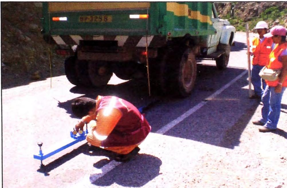
**FOTO 19: Una vez colocado el equipo de la VB se procede a la toma de mediciones a 0, 25, 50, 75cm.**
