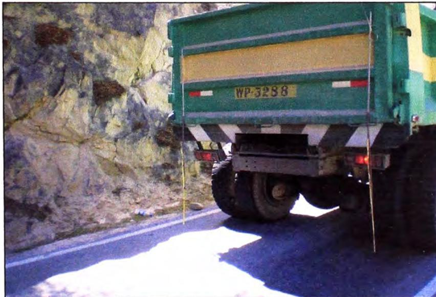
Foto 2.2. Eje trasero del camión volquete
