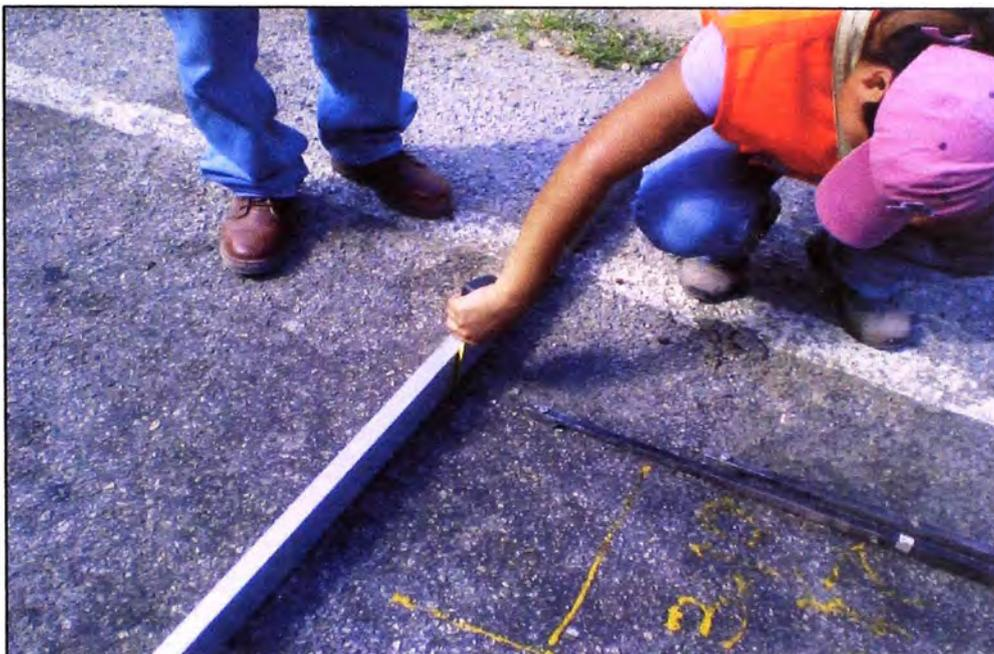
FOTO 20: Luego se realiza la medición del ahuellamiento en el punto de ensayo
