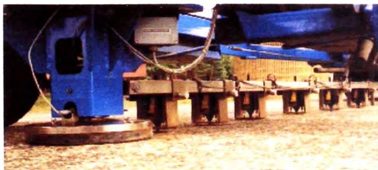
Figura 4.5. Equipo FWD en prueba
