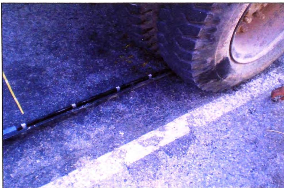
FOTO 17: Colocación de la Viga Benkelman en el punto de ensayo
