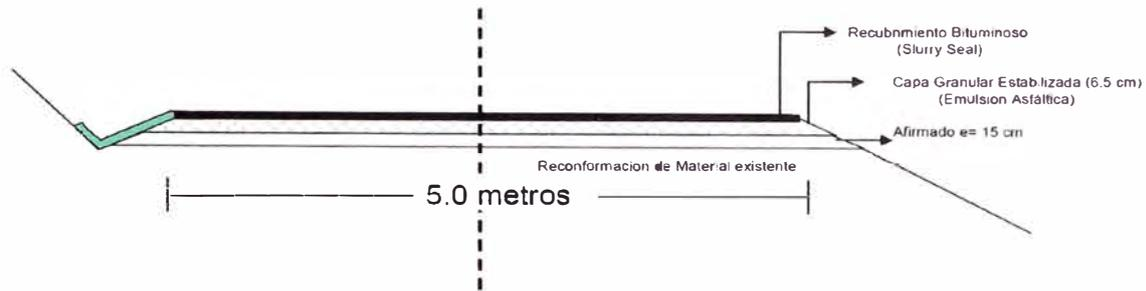
Figura 4.8. Sección típica del pavimento
