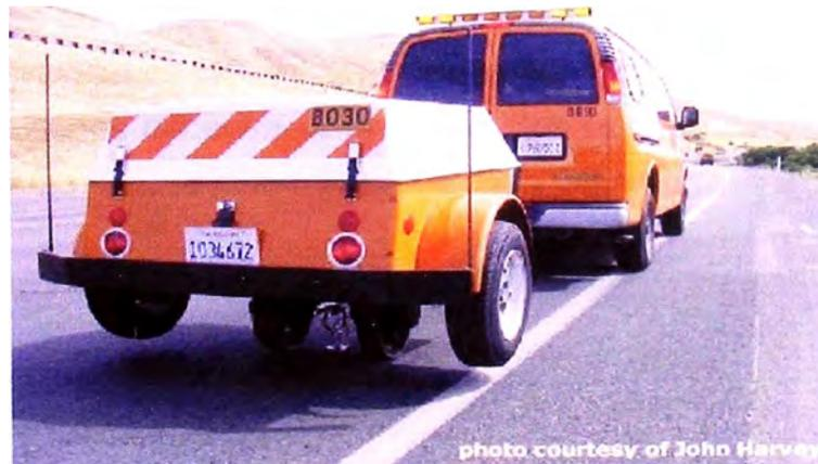
Figura 4.3. Equipo Dynaflec transportado
