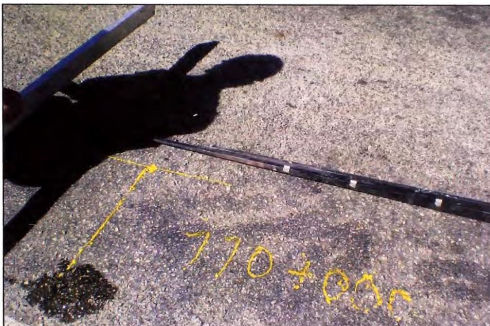
FOTO 16: Se define los puntos de ensayo con una marca transversal al pavimento. Punto Km. 110+000
