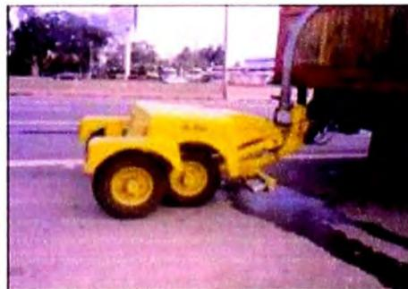
**Figura N° 1.23: Equipo Mu-Meter**
