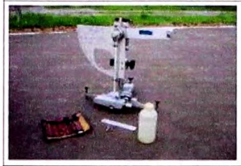
**Figura N° 1.25: Equipo Péndulo de Fricción**
