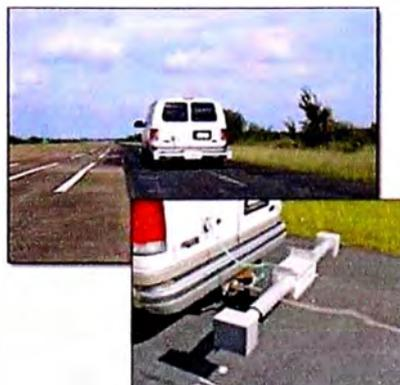
**Figura N° 1.12: Ejemplo de equipo Perfilómetro de alta frecuencia.**
