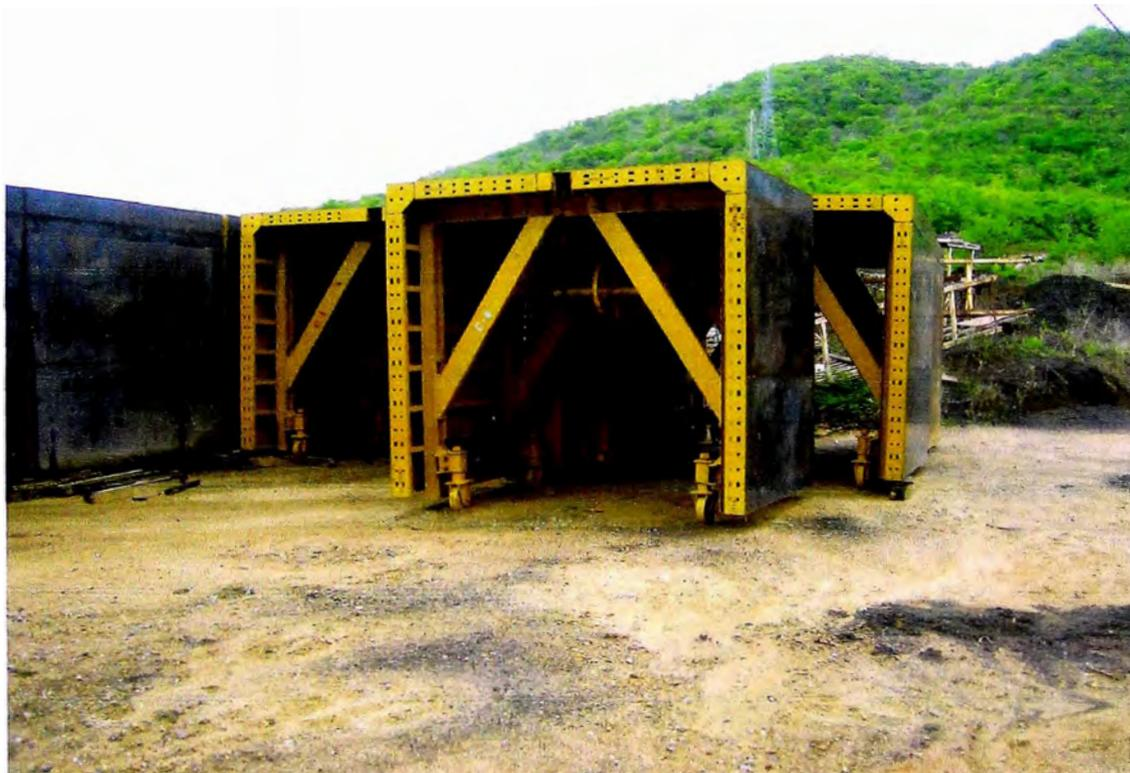
**Figura No 3.1 Encofrados de Sistema Túnel tipo "U" invertida,
